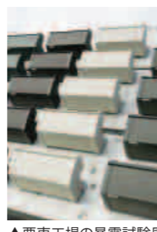
▲栗東工場の暴露試験風景(南面35°傾斜)
